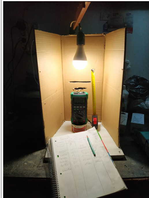
Иллюстрация 2: Схема установки для измерения освещенности
